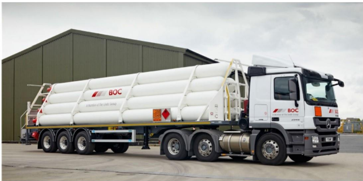
Een tube-trailer met 9 stalen drukcilinders ( 200 bar ) (M-Tech, 2020)
