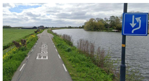
Figuur 7-3: Bebording en een duidelijke verbreding van de weg vergroten de zichtbaarheid van passeerhavens
