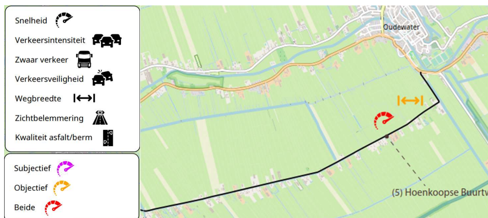
Figuur 6-1: Een overzichtskaart van de Hoenkoopse Buurtweg inclusief de objectieve en subjectieve knelpunten
