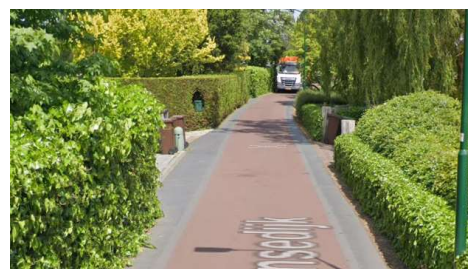
Figuur 6-2: Visueel versmallen van de rijbaan met een smalle rijloper over het midden van de verharding
