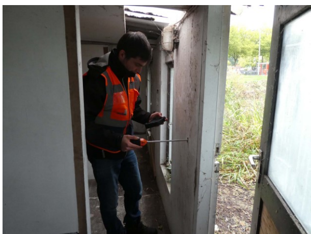
Figuur 17 Endoscopisch onderzoek in de muur
