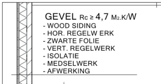
Figuur 2.7. opbouw geveldelen.
