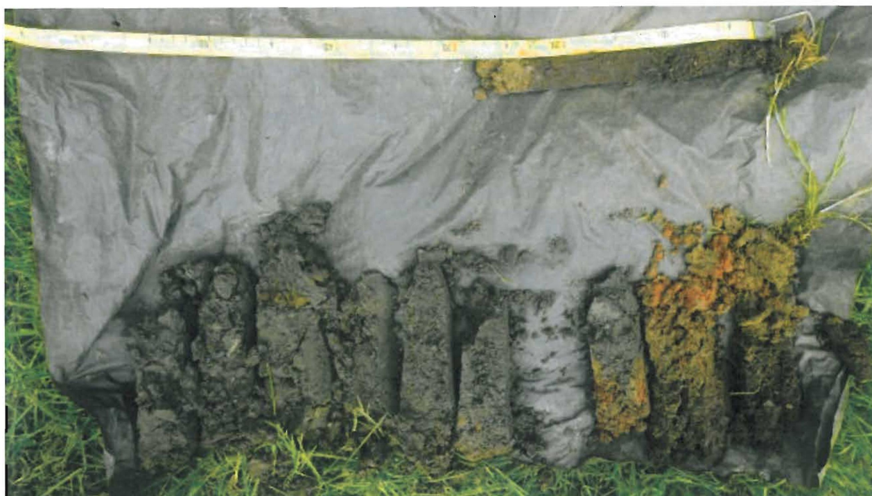
Boring 2: Opname boorkernen en gutskern.
