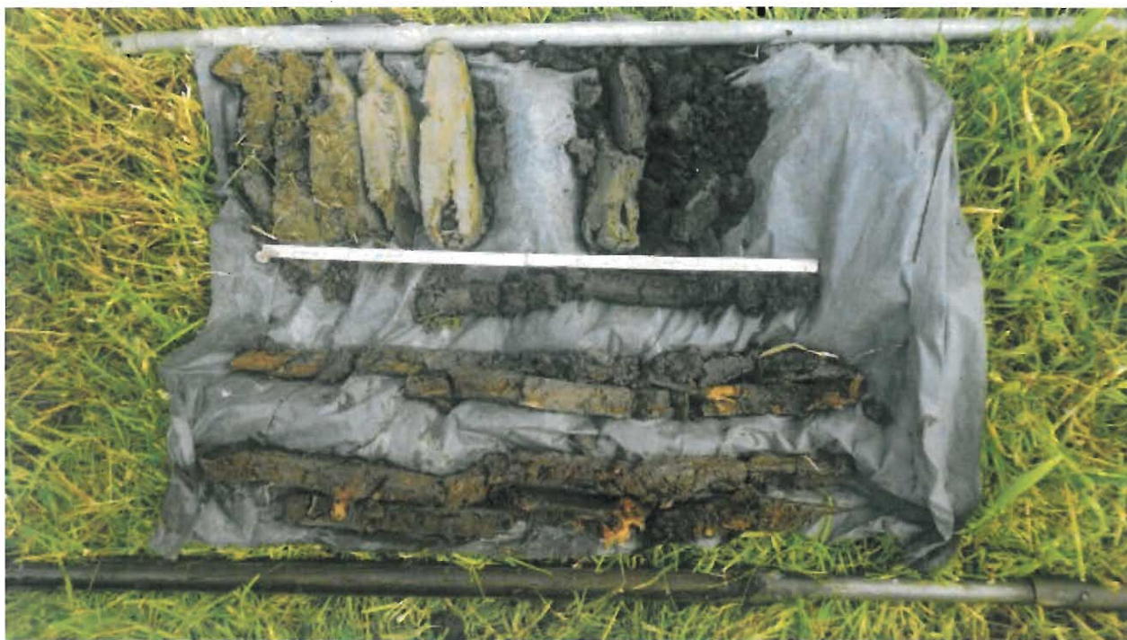
Boring 6: Opname boorkernen en gutskernen.
