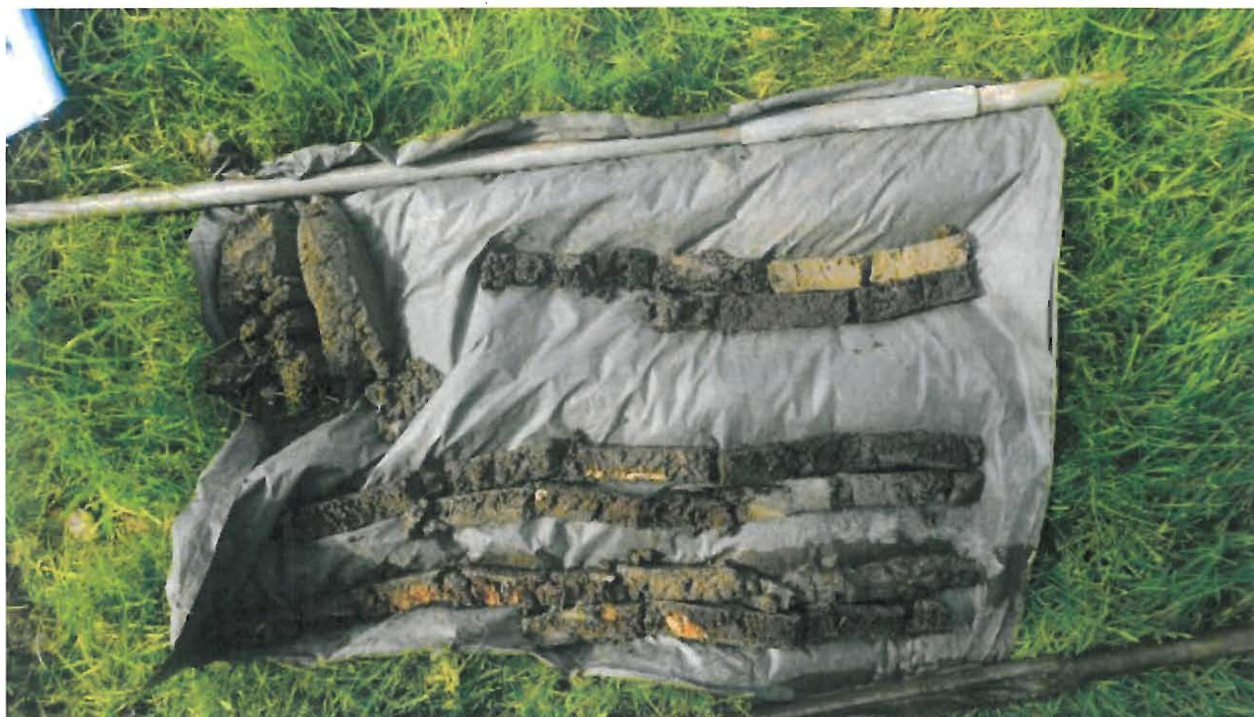
Boring 7: Opname boorkernen en gutskernen.
