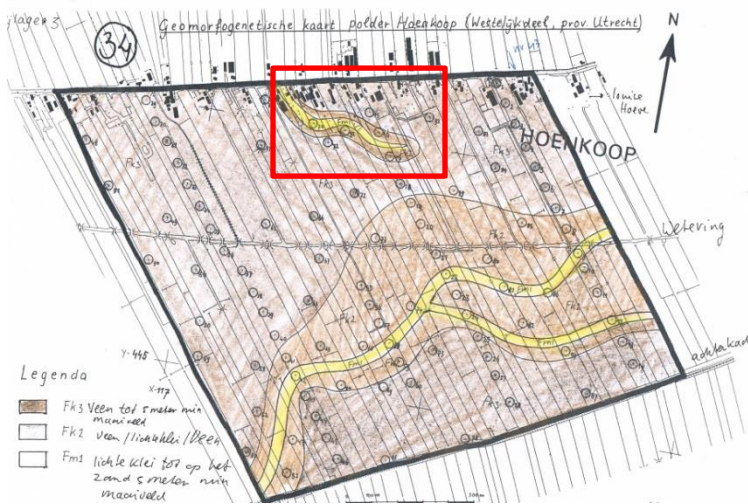
Figuur 15: De boorgegevens in het bezit van dhr. Broere. In de bovenste 5 m van de bodem zijn een crevasse en een stroomgordel aangetroffen.
